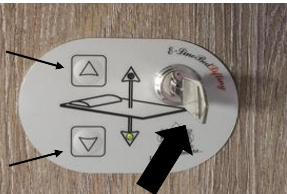
Mit einem speziellen Schlüssel -> Kindersicherung <- lässt sich die elektrische Hubfunktion, welche mit 2 Pfeilen, einmal nach oben und einmal nach unten gerichtet sind. einschalten
