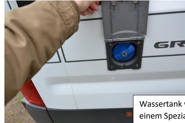
Wassertank wird mit einem Spezialschlüssel geöffnet, welcher mit dem Autoschlüssel dazu gegeben wird. (Befindet sich hinten rechts)
