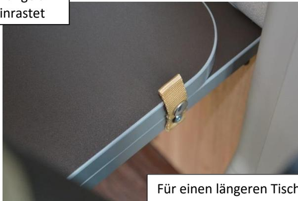
Für einen längeren Tisch öffnen Sie die Sicherung an der Seite und fahren Sie die Beine unter dem Tisch aus
