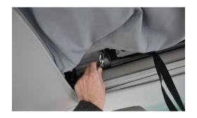
Schritt 1.4: Öffnen der Klappdachverrieglung
