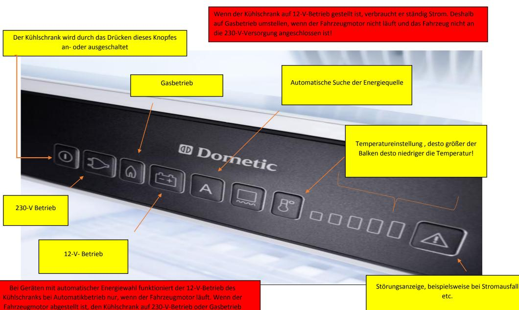
Wichtig! Bei Gasbetrieb hat der Kühlschrank seinen besten Wirkungsgrad. Bei 12-V Betrieb hält der Kühlschrank nur die Isttemperatur also bei Gelegenheit den Kühlschrank auf dem Campingplatz etc. an den 230 – V Anschluss (siehe unten) anschließen!
